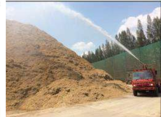
ติดตั้งตาข่ายป้องกันฝุ่นรอบกองเชื้อเพลิง ฉีดพรมน้ำลานกองเชื้อเพลิงเพื่อลดการฟุ้งกระจายของฝุ่นละออง
