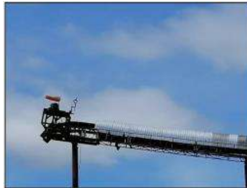
ติดตั้งถุงลมบดทิศทาง ระบบสายพานลำเลียงเชื้อเพลิงเป็นระบบปิด
